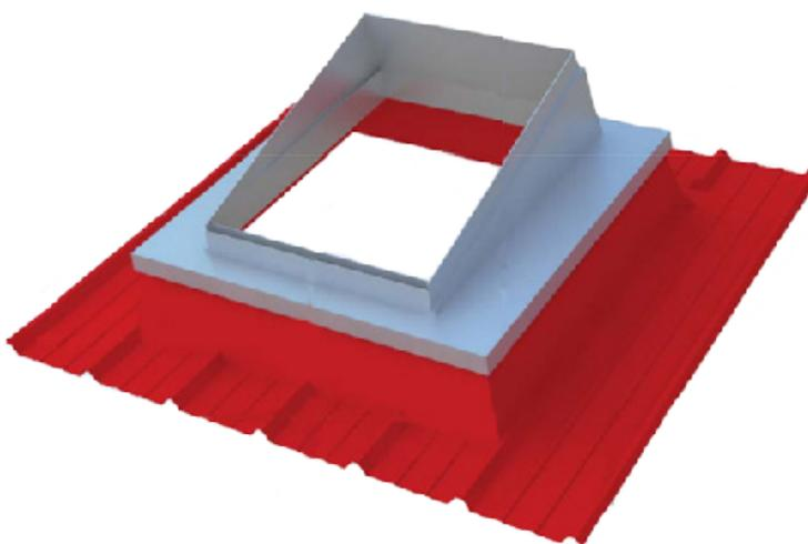
Le kit d'Intégration de Fenêtre De Toit (IFDT) de SKYDÔME<sup>®</sup> est destiné à recevoir une fenêtre de toit (à rotation centrale uniquement) pour l'adapter sur bac sec ou panneau sandwich. Composé d'une embase polyester avec costière isolée, ce kit permet l'intégration optimale d'une fenêtre de toit pour un rendu discret et
